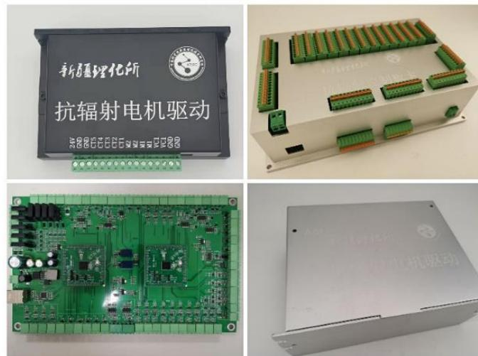
图 3 抗辐射机器人控制器
