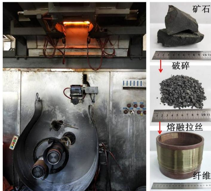
图1. 玄武岩纤维拉丝装置及制备过程
