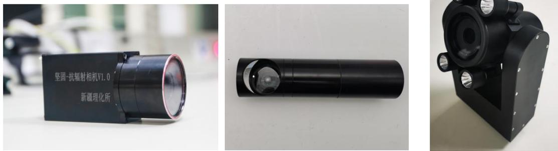
(a) 监控相机 (b) 小型化潜望相机 (c) 水下视频检查相机
